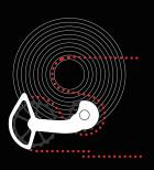
STEP 1 チェーンをリヤカセットのトップ、フロントチェーンリングのインナーギア に変速します。
