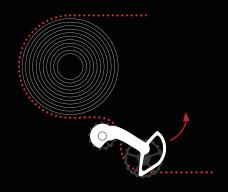
STEP 3 チェーンを適切な長さに切ったらカセットのローギアに変速し、OSPW との間隔を確認します。ケージを半時計方向(図の矢印の向き)に動かせるはずです。OSPWのアッパープーリーとカセットのローギアには、ある程度の間隔が必要です。この間隔が不十分であれば、Bテンションボルトを調整します。
