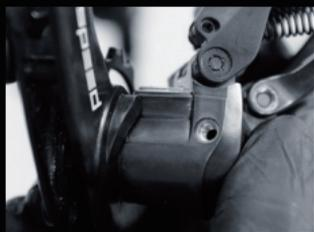
12. OSPWケージをディレラー本体に押し付けながら、ケージの突起がディレラー本体の突起を通り過ぎてから噛み合うまで、反時計方向(バイクの上側、後ろ側、下側の順)に回します。
