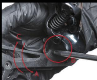
3. ディレラーをケーブル接続部の上側まで移動させます。片手でフロントケーシングプレート (A) を下向きに回し、プラスのプリーケーシングストップスクリュー (B) を外します。プリーケーシングのスプリングのテンションを解放させます。このとき、ディレラーケーシングの位置が上下逆さまになっているはずです (C)。
