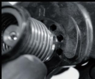
9. OSPWでは、H(ハイ)からL(ロー)まで4種類のスプリングテンションを選べます。Lにセットすると、チェーンのテンションとスプリングの抵抗が減り、変速性能もやや落ちます。Hにセットすると、最高の変速性能を得られませんが、他のセッティングよりもスプリングの抵抗がやや増えます。
