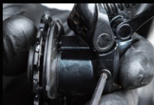
13. 手順3で取り外したT10ボルトを付け直し、ケージを固定します。
