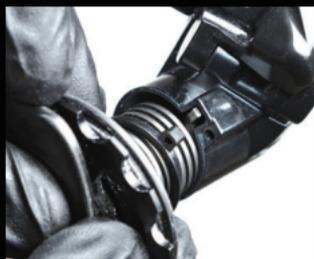
11. ディレラー本体を回し、OSPWケージがバイク前方を向いた状態で、OSPWの取付用ポストをディレラー本体裏側に合わせます。スプリングとプラスチックスペーサーをディレラー本体の溝に合わせ、ケージをディレラーの奥まで押し込みます。
