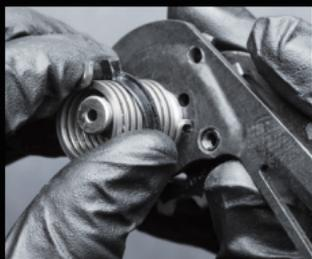
6. ケーシングからスプリングとプラスチックスペーサーを取り外します。スプリング端部のフックはプーリーケーシングに引っ掛かっています。スプリングとスペーサーはOSPWの取付け後も使用しますので、保管してください。
