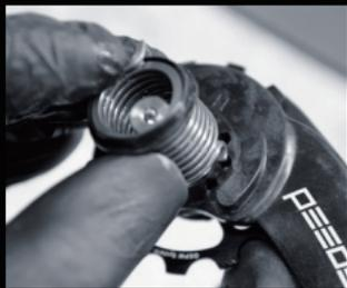
8. 元のスプリングとプラスチックスペーサーを、ケーシングから取り外したときの要領でOSPWの取付用ポストに合わせます。スプリングのフック側とスペーサーの平面側をOSPWに向けます。
