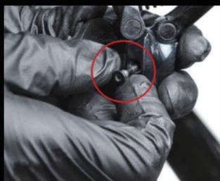
4. ディレラー本体裏側にある黒色の取付用 T10 ボルトを T10 Torx レンチで外します。ボルト全長の半分までねじが切られています。ボルトを 1cm ほど緩め、ねじがかからなくなったら、指でボルトを引き抜きます。
