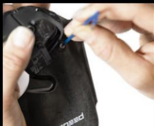
11. ケージプレートを前方に回し、2.5mmの六角レンチを使って回転ストップボルトを3Nmのトルクで締め付けます。
