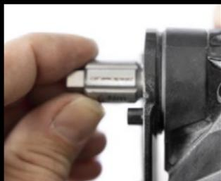
9. 中央のネジに元のケージナットをねじ込みます。付属のナット取付用ツール(4つの突起がついたツール)を使用して、センタースクリューに取り付けます。指でしっかりと締め付けた後、360度回します(1回転させます)。
