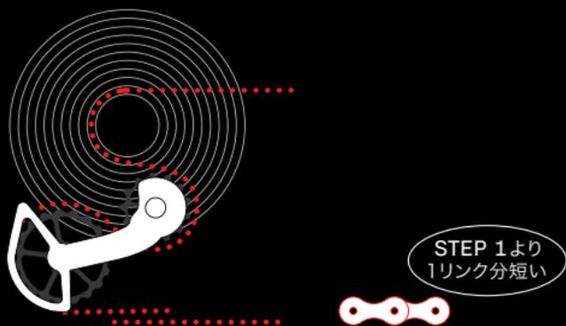
STEP 2 チェーンにテンションがかかり、OSPWシステムが上図のように整列しているように見えたら、チェーンを1リンク（インナーリンクとアウターリンクの組み合わせ）短く切り、すべてのギアに適切なチェーンのテンションがかかるようにします。
