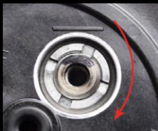
10. D型センターポストにつけた印とケージプレート裏側の線との位置関係をメモします。ケージプレートをセンターポストに向かって時計方向に回し、メインセンターナットが回ったり締まったりしないことを確かめます。
