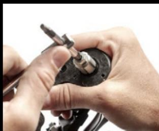
3. フロントケージプレートをディレイラーごとを掴み、付属の専用ツールでメインセンターナットを緩めます。
