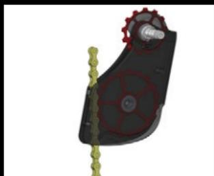
14. 残りのチェーンがよじれていないことを確認し、もう一方のチェーンの端をケージの後部に送り込みます。
