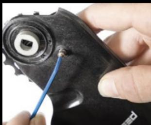
5. OSPWを開封し、回転ストップボルトを取り外します(ケージを取り付けたら付け直します)。OSPWの裏側から4個のボルト全てを取り外して分解します。
