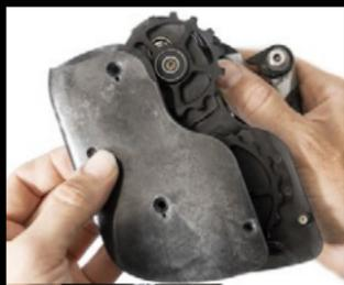
12. OSPWエアロケージのアップパーポストに15歯プーリーを、ローパーポストに19歯プーリーを取り付けます。プーリーの印を外側(ケージプレートのロゴがある側)に向けます。バックケージプレートを載せ、2.5mmの六角レンチを1.5Nmのトルクで取り付けます。上下のタワーボルトは2.0mmの六角レンチで0.9Nmのトルクで締め付けます。
