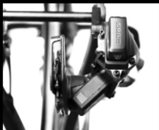
1. バイクをスタンドに固定し、チェーンとリアホイールを取り外します。ディレイラーを上にならずして、後輪を取り外します。
