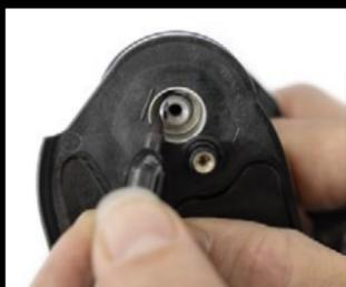
6. フロントケージプレートを掴み、リアディレラー内にあるD型センターポストを止まるまで半時計方向に回します。その後、フロントケージプレートを取り外します。
