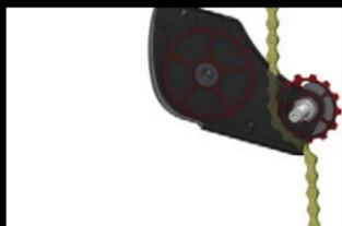
13. ディレイラーを自転車に取り付けます。カセットをトップギアに変速し、リアホイールを取り付けます。
