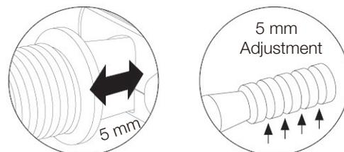
プラットフォームとクランクアームの間の距離は、5mm延長または短縮できます。ペダル幅を調整するには、ハーフシェルのネジを緩め、ペダルシャフトの位置を変更します。メンテナンスも参照してください。これにより、大きな靴用のスペースが追加されます。
