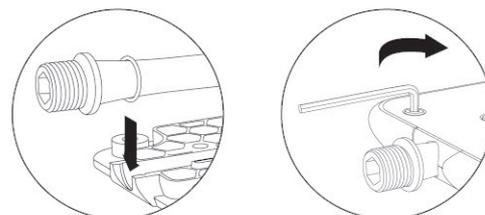
Oリングを所定の溝にはめ込み、ハーフシェルを締め付けます。
