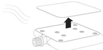
六角ネジでペダル側の三角形のマークに注意してください。ヘアドライヤーで熱を加えてグリップテープを剥がします。
